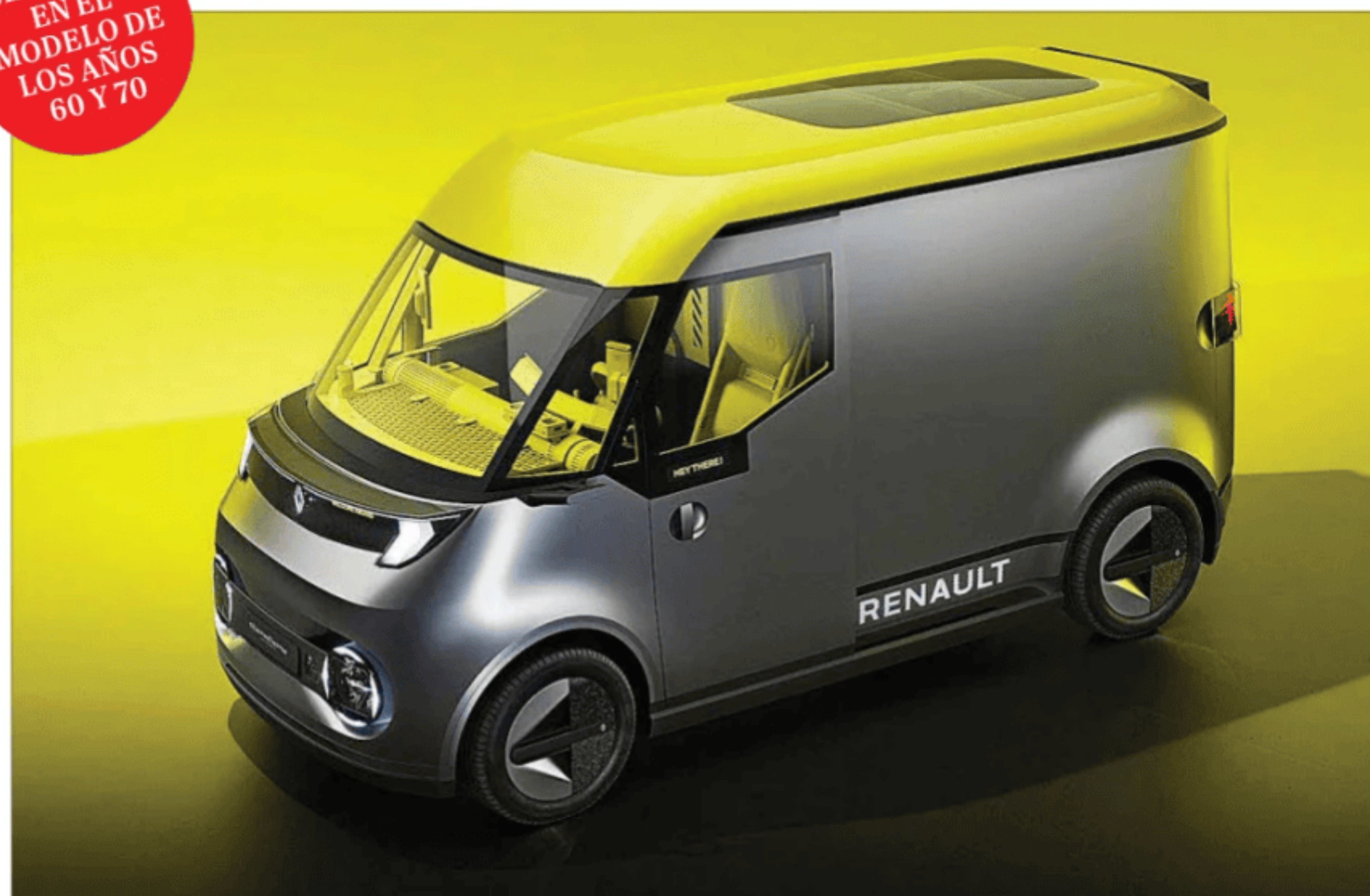
El 'concept car' Estafette es una furgoneta pequeña (4,87 m), pero con gran capacidad de carga y que permite estar dentro de ella de pie.
